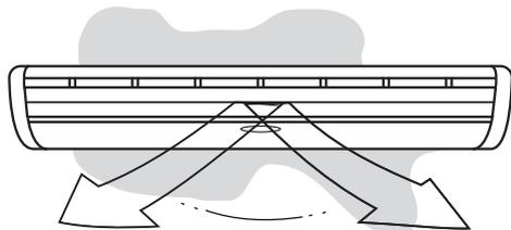
Regular **manualmente** os defletores verticais para alterar a direção do fluxo de ar para esquerda ou para direita, movendo as alavancas dos defletores (a posição destas poderá variar conforme o modelo).
