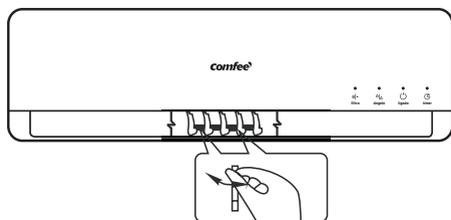
Durante o ajuste deve-se prestar atenção para não pôr os dedos no ventilador, nem no defletor de direção horizontal, cuidando para não danificar os defletores verticais.
