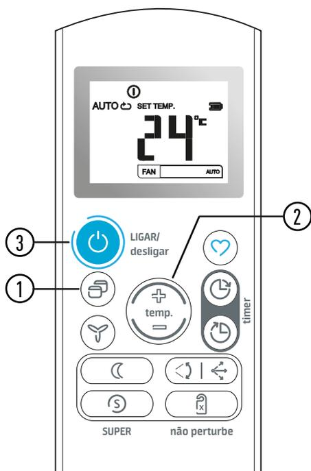
Quando a unidade for configurada no modo **AUTOMÁTICO (FAN)**, os modos **REFRIGERAÇÃO (COOL)** ou **VENTILAÇÃO (FAN)**, são selecionados automaticamente conforme a temperatura ambiente e a temperatura selecionada no controle remoto.
