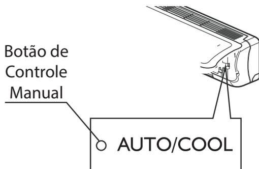
1. Abrir e levantar o painel dianteiro até ficar fixo emitindo o clique de encaixe.
