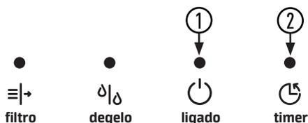
O LED indicador de funcionamento **ligado** em combinação com o LED indicador do temporizador **timer** piscam conforme a necessidade de limpeza ou substituição do filtro de ar.
