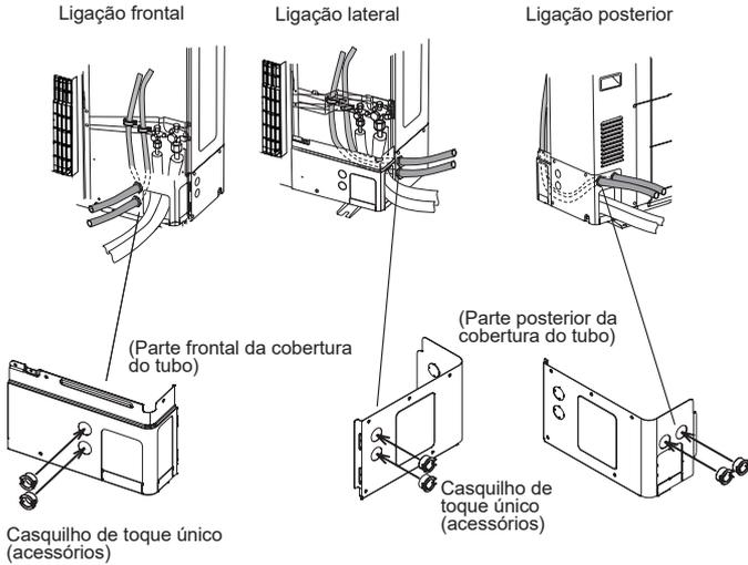
**NOTAS:** Certifique-se de que o cabo de alimentação e os cabos de ligação não são instalados através do mesmo orifício. Devem ser instalados em dois orifícios separados para evitar danos nos cabos.
