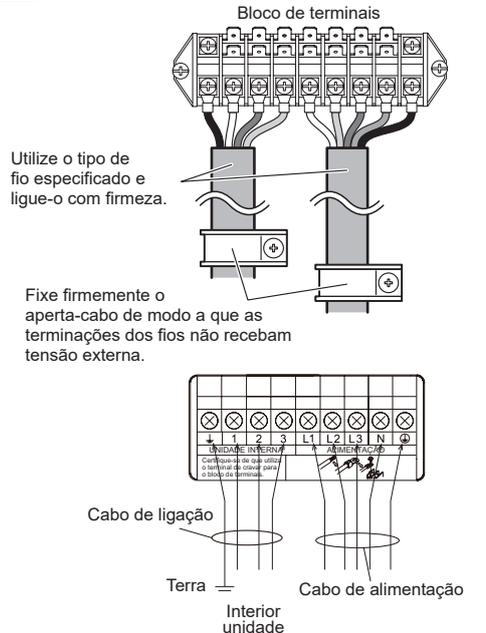
(4) Fixe os cabos com a braçadeira de cabo apertada à base das válvulas.
