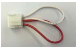
Figura 2. Fiação em Jumper
