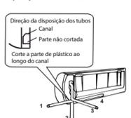
**NOTA:** Quando estiver fixando os tubos ao longo das direções 1, 2 ou 4, corte a parte de plástico correspondente.
