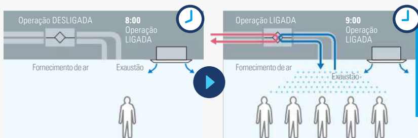
As configurações do temporizador de atraso podem ser ajustadas.
